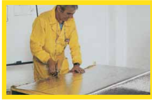
Kesim işleminden sonra, levhaların katlanıp birleştirilen kenar üzerinden zımbalama yapılması
