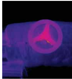
İzocam Vana Ceketini uygulandıktan sonra yalıtımlı vananın termal kamera görüntüsü
